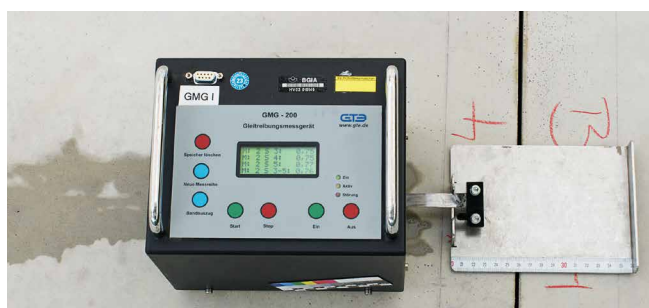
Abb. 3: Messung des Gleitreibungskoeffizienten mit dem GMG-Gerät
