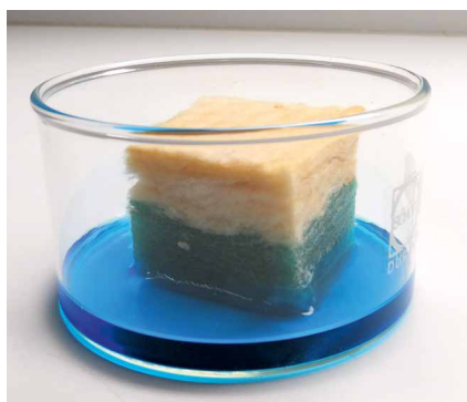
Abb. 1: Unterschied der Saugfähigkeit von Mineralfaserdämmstoffen mit (links) und ohne (rechts) Hydrophobierung; Zustand nach einstündigem Kontakt mit blau gefärbtem Wasser
