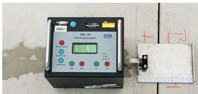
Abb. 3: Messung des Gleitreibungskoeffizienten mit dem GMG-Gerät
