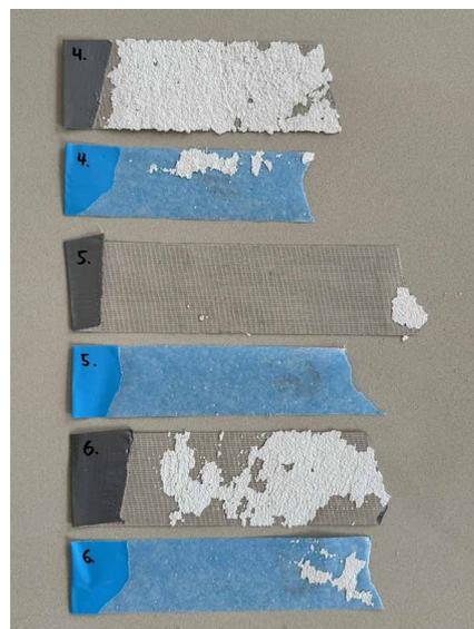
Abb. 3: Klebebandabzüge Rückseite
