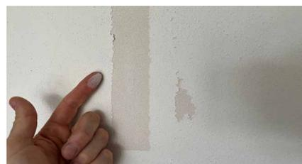
Abb. 1: Klebebandabzugsprobe vor Ort
